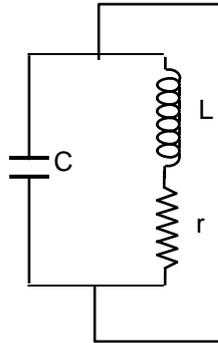
$r$  est la résistance ohmique de la self  $L$ . Calculons l'admittance  $Y$  du dipôle correspondant :
