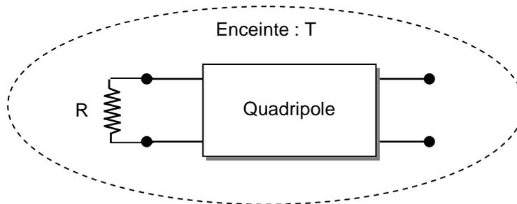
La puissance maximale de bruit, disponible aux bornes de la charge adaptée  $R$  est, dans la bande  $\Delta F$  :
