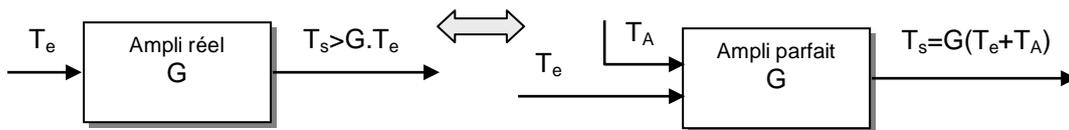
L'amplificateur parfait devra avoir le même gain  $G$  que l'amplificateur réel, la température de bruit  $T_s$  est identique à la sortie des deux amplificateurs. Dans le cas de l'amplificateur parfait nous pouvons écrire :
