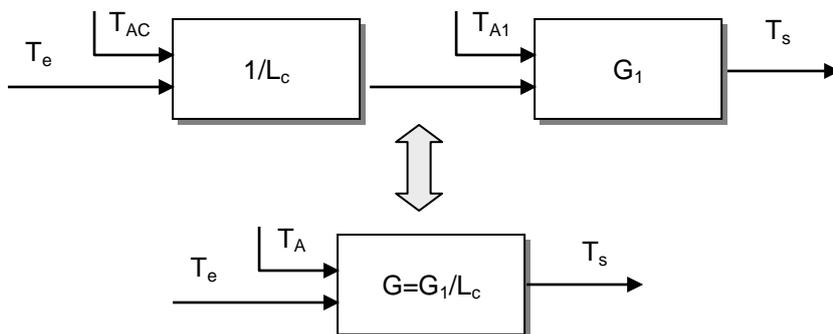
Cherchons la température additionnelle de bruit de l'amplificateur équivalent et pour cela appliquons la relation de l'amplificateur parfait aux deux schémas ci-dessus, il vient :
